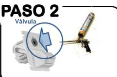
Fijar la pasacinta con espuma PU por la válvula.
